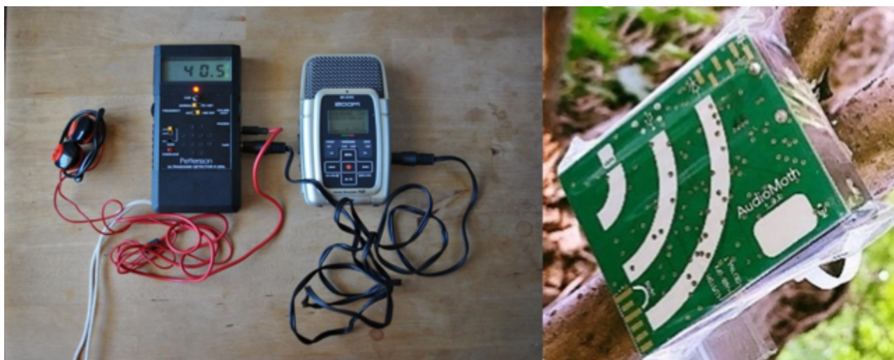
Figura 23 – Strumentazione per i rilievi ultrasonori: a sinistra bat detector manuale D240 X Pettersson Elektronik e registratore digitale Zoom H2; a destra AudioMoth 1.2.0
