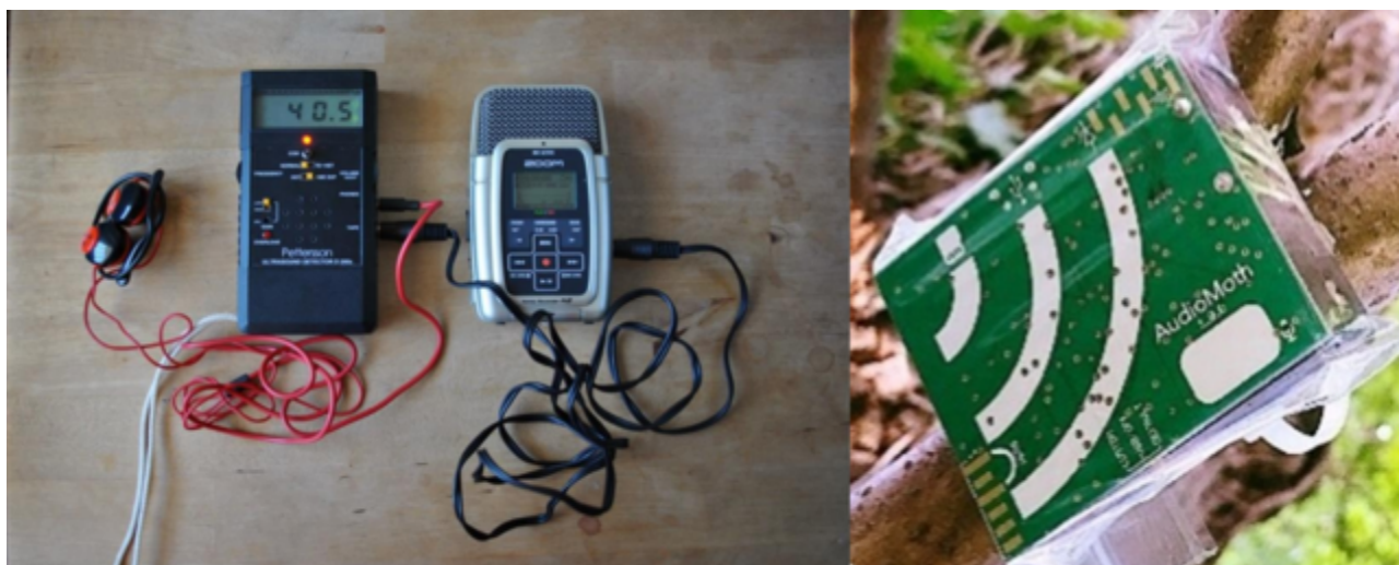
Figura 63 – Strumentazione per i rilievi ultrasonori: a sinistra bat detector manuale D240 X Pettersson Elektronik e registratore digitale Zoom H2; a destra Audiomoth 1.2.0.
