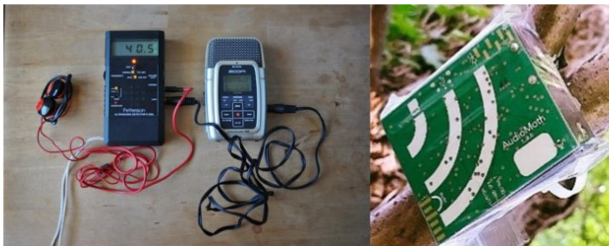
Figura 119 – Strumentazione per i rilievi ultrasonori: a sinistra bat detector manuale D240 X Pettersson Elektronik e registratore digitale Zoom H2; a destra Audiomoth 1.2.0.
