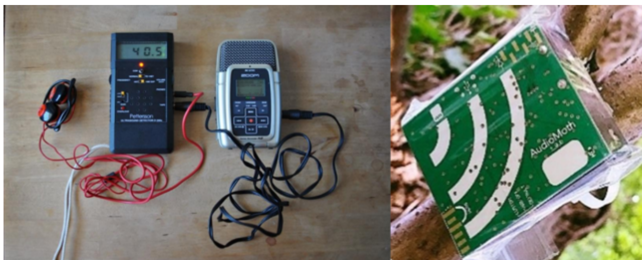
Figura 30 – Strumentazione per i rilievi ultrasonori: a sinistra bat detector manuale D240 X Pettersson Elektronik e registratore digitale Zoom H2; a destra AudioMoth 1.2.0.
