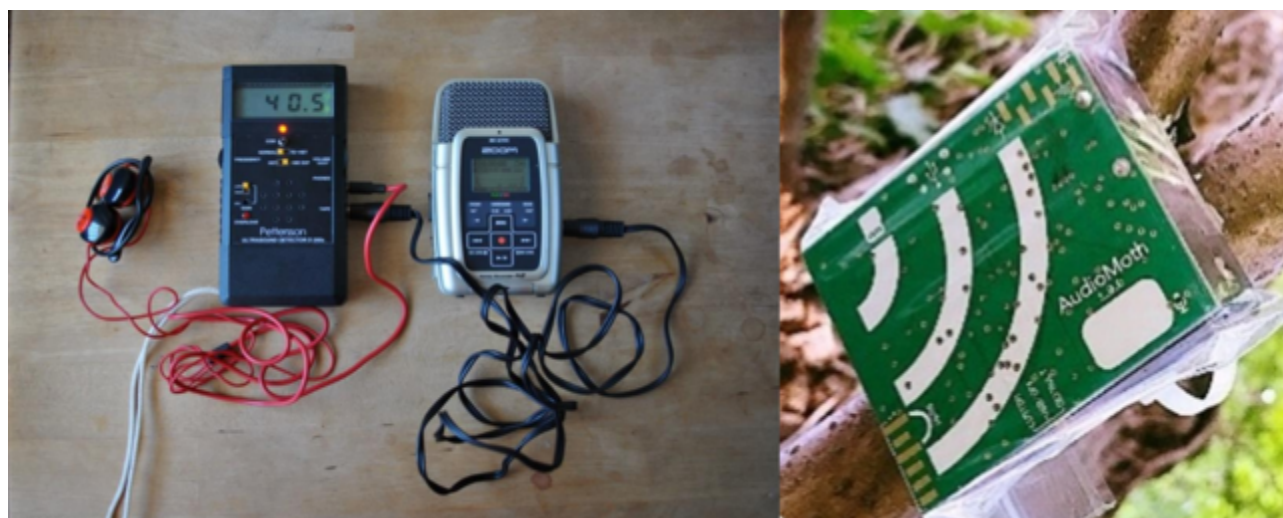
Figura 43 – Strumentazione per i rilievi ultrasonori: a sinistra bat detector manuale D240 X Pettersson Elektronik e registratore digitale Zoom H2; a destra AudioMoth 1.2.0.
