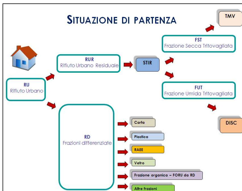
Figura 2.1.1_Schematizzazione del Ciclo dei Rifiuti Urbani in Campania - Situazione di partenza per il PRGRU 2012
